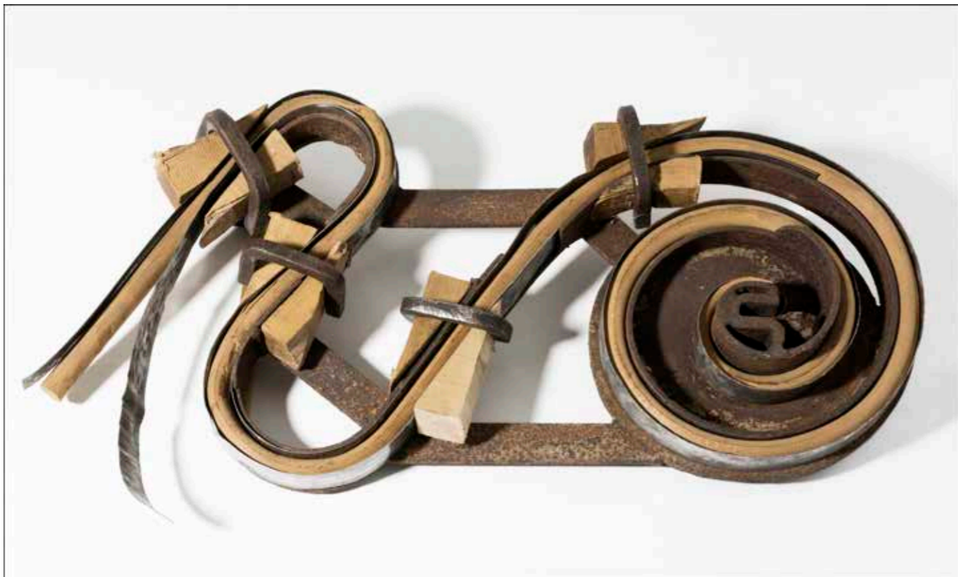
Motlle metàl·lic per fer una peça lateral d'un balancí. Curvados Sanchís (Catarroja). *
