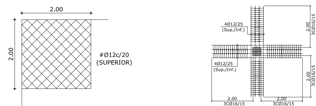
REFUERZO DE ESQUINAS ESQUINAS APOYADAS EN MURO AL MENOS EN UNO DE SUS LADOS
